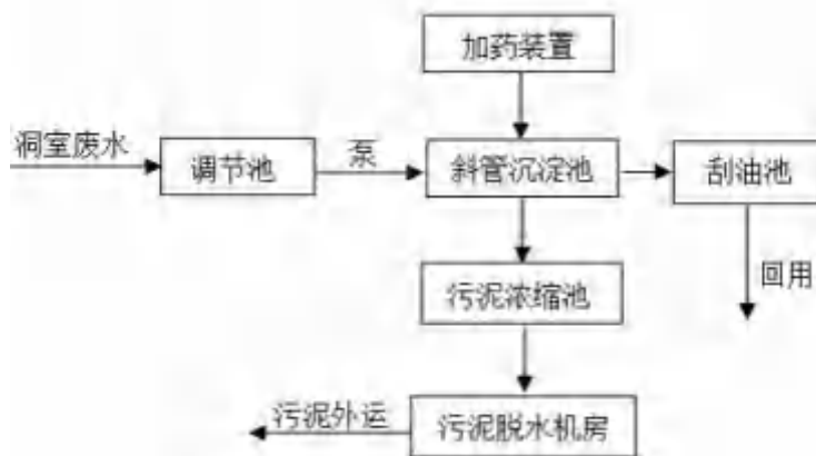
图 4.1-13 洞室废水处理工艺流程图
